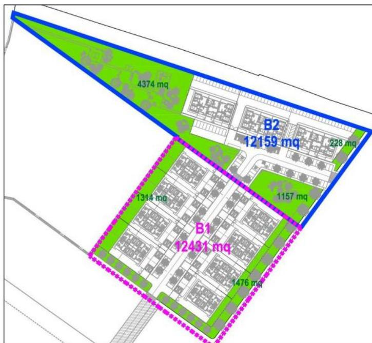
Figura 2 - Superfici considerate ai fini del calcolo dei volumi di laminazione. Fonte: D2 Relazione idraulica
