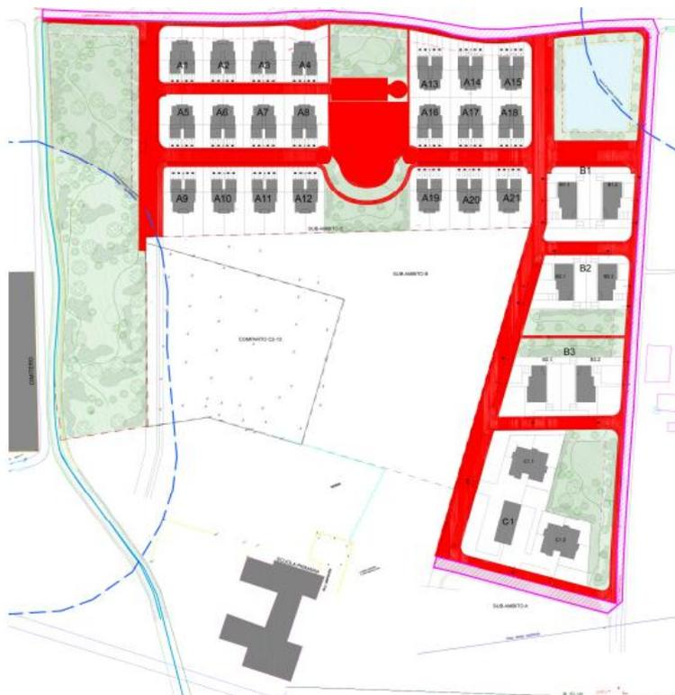
Figura 4 - Aree considerate per il volume di laminazione pubblico (in rosso la viabilità interna, in azzurro la vasca di laminazione, in magenta le strade extra comparto) Fonte: F.02 Relazione idraulica e PGRA
