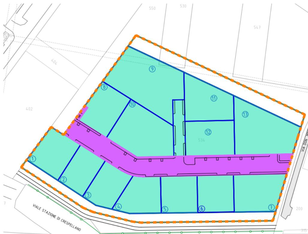
Figura 1 - Identificazione delle aree per la verifica dell'invarianza idraulica. In verde le aree private e in rosa le aree pubbliche.
