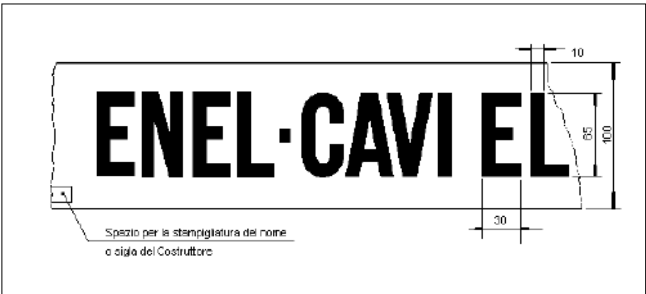
Figura 8 – Nastro di segnalazione
